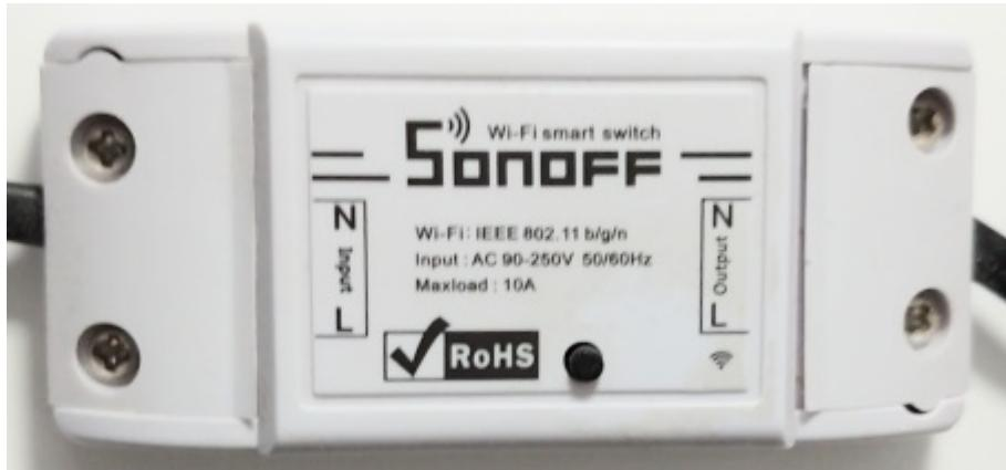
Der Anschluss erfolgt nur über einen 2poligen Kabel, welcher kein PE-Leiter enthält.
