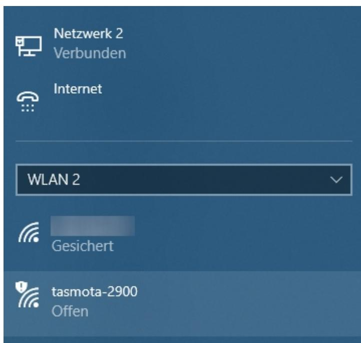
Nach dem Tasmota auf das Gerät installiert wurde wird nach den Neustart des Gerätes ein WLAN-Accesspoint durch die Firmware erstellt. In diesen Beispiel „tasmota-2900“.
